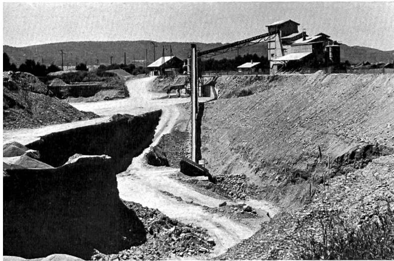
Bilder 15 und 16 Kiesgruben oben: ohne in das Grundwasser reichenden Abbau (richtig); unten: Ausbeutung bis in das Grundwasser reichend (abzulehnen).
