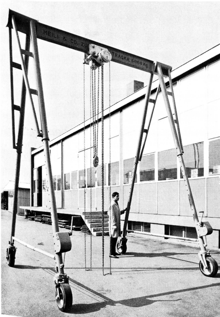
Bei der teleskopischen Ausführung lässt sich die Höhe des Bockkrans der Höhe vorhandener Räume oder der Last anpassen.
