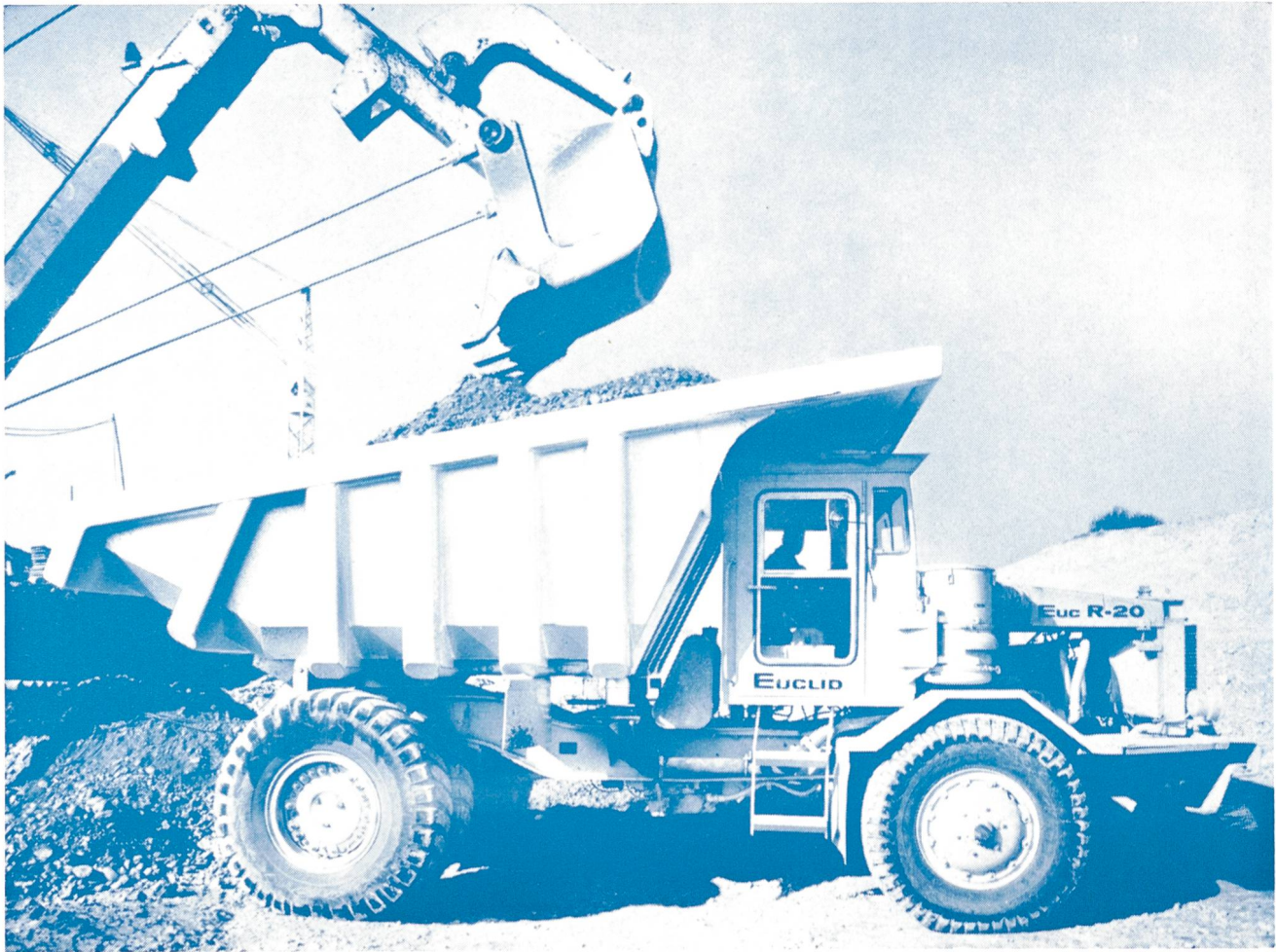
Kippmulde auf Euclid-Dumper im Einsatz auf Grossbaustelle für Kies- und Felstransporte
