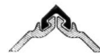
Winkelecksstück BELVAL Gewalztes Spezialprofil für rechtwinklige Ecken Gewicht pro m = 12 bzw. 14 kg
