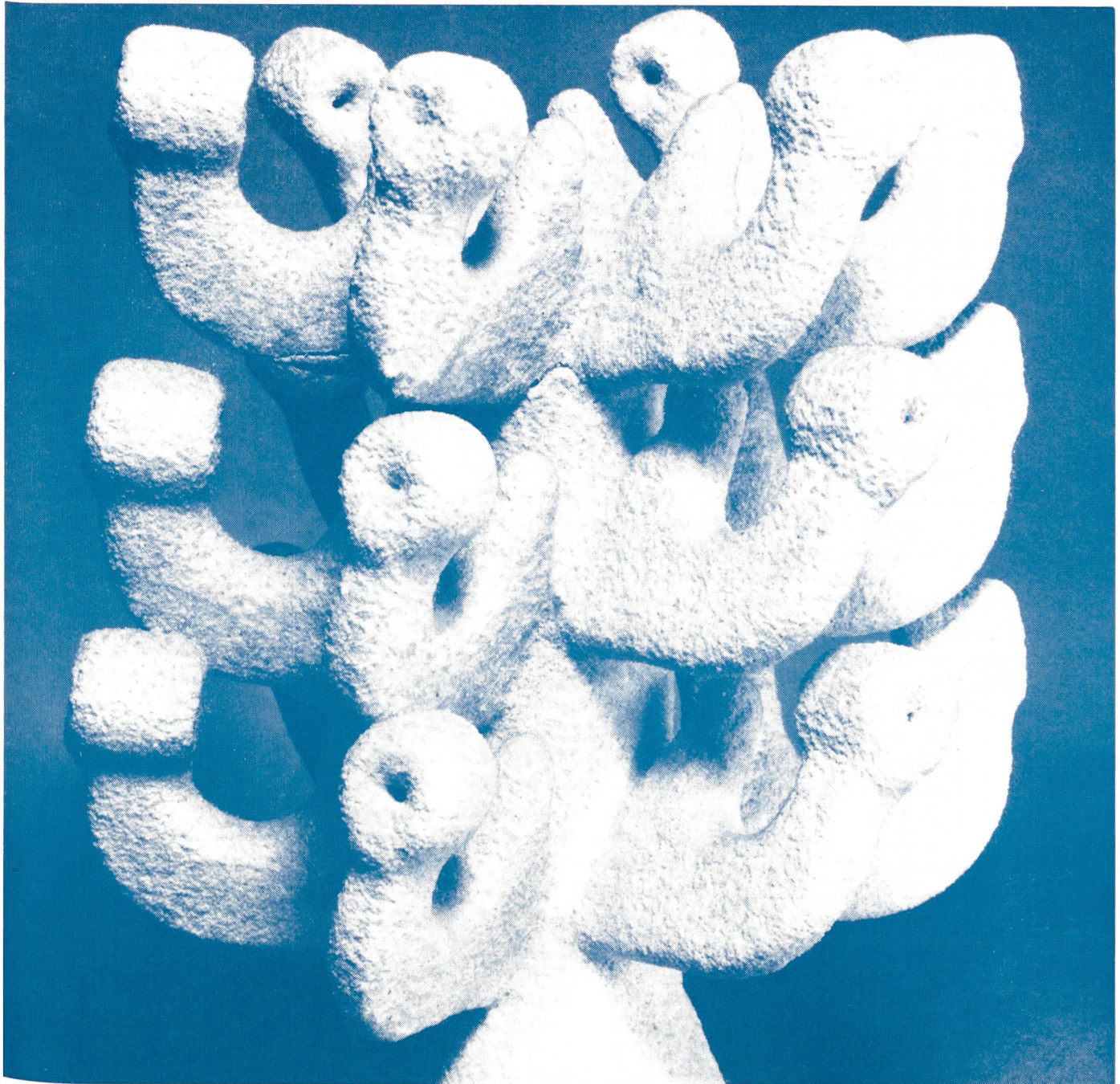
Sulzer-Präzisionsguss-Verfahren: Hohlform aus keramischer Masse für 18 Mikrometerbügel im Stückgewicht von 120 Gramm
