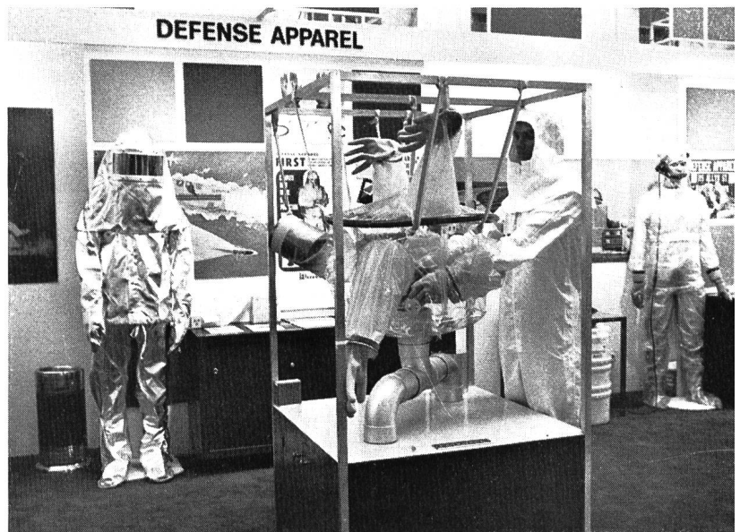
Bild 10 Schutzgehäuse für Arbeiten an strahlenden oder giftigen Objekten Foto: Dierks, Basel
