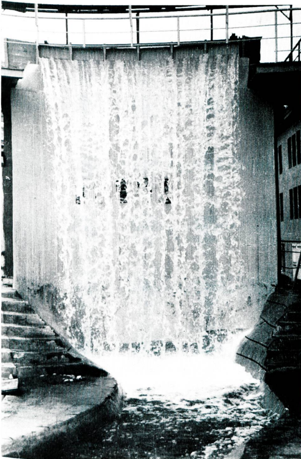
Bild 9 Modellversuch im Massstab 1:40 des Kronenüberfalls mit sechs Oeffnungen von je 25 m für die Ableitung von 1800 m 3 /s.
