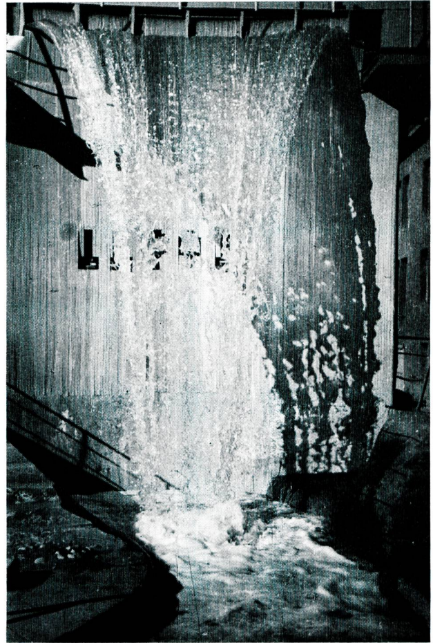
Bild 10 Wie Bild 9 nach Einbau von Strahlableitkern in den beiden äusseren Oeffnungen.
