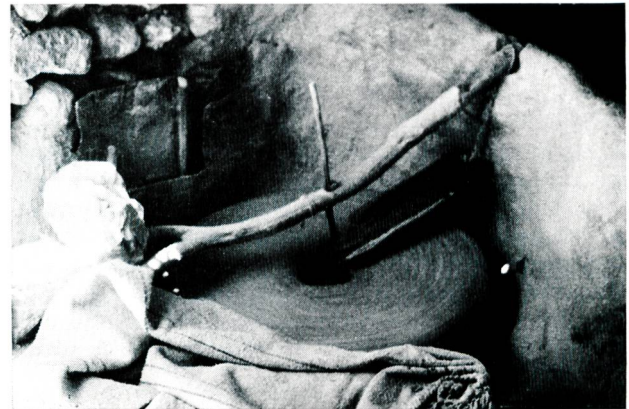
Bild 40 Mahlanlage mit schwingender Korneingabe im Mühlenkraftwerk Bend-e-Emir.
