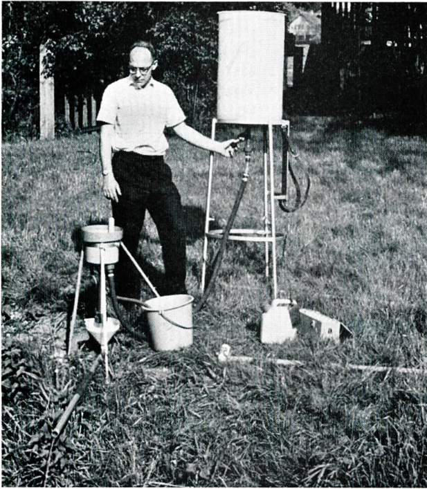
Bild 7 Heutige Installation für Messungen mittels Natriumbichromat, anwendbar für Abflussmengen bis 100 m 3 /s.
