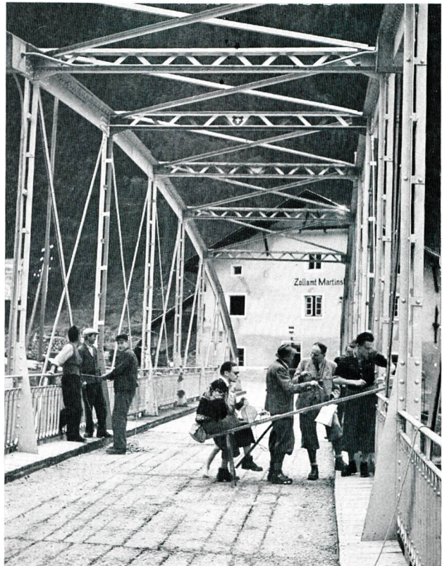
Bild 3 Simultane Messung der Abflussmenge des Inn bei Martinsbruck durch je eine österreichische (Tirolisches Landesbauamt, Innsbruck), und schweizerische (Amt für Wasserwirtschaft) Equipe am 13. 9. 1948, zur Feststellung, ob die in den zwei Ländern angewendeten, etwas voneinander verschiedenen Geräte und Methoden übereinstimmende Resultate ergeben. Die Differenz zwischen den beiden Resultaten betrug 0,2%; sie lag somit innerhalb der Messtoleranz.
