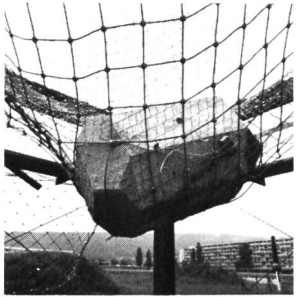
Bild 4 Versuchsblock im Versuchsnetz. Mit Betonklötzen von 200 kp und 1000 kp wurden Fallversuche durchgeführt, wobei die Fallhöhe bis 20 m gesteigert wurde.
