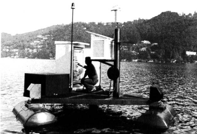
Die automatische schwimmende Messstation auf dem Luganersee.
