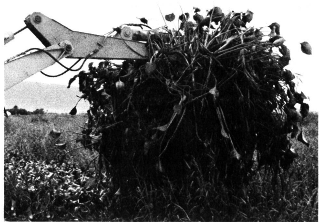
dredge H 250 travaille dans une des vallées à proximité de Mandeville. C'est une région marécageuse sillonnée par des canaux d'irrigation entièrement couverts d'un tapis de plantes aquatiques. Ces canaux doivent être maintenus ouverts. Le dragage à l'aide d'une dragline munie de chenilles n'a guère été un succès. L'IHC dredge avec sa benne preneuse enlève cette masse résistante des plantes aquatiques et manœuvre avec une facilité étonnante. Cette dredge procède non seulement à l'enlèvement des plantes aquatiques, mais également à l'élargissement des canaux.
