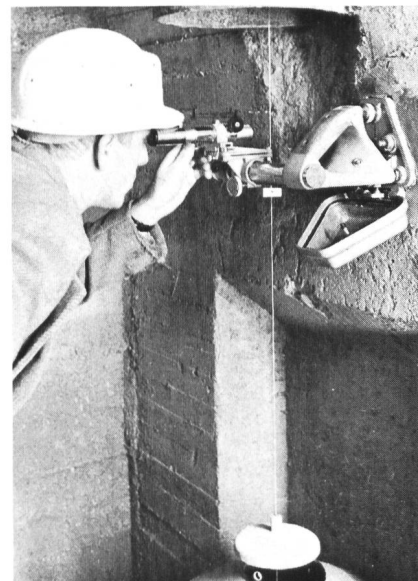
Figure 3. Au sein du barrage de Linth-Limmern d'une hauteur de 146 m, le spécialiste observe les déviations du fil du pendule, qui depuis le couronnement du barrage est suspendu librement dans un puits de plus de 100 m de profondeur. Après l'examen des déviations il est possible de tirer des conclusions sur le comportement du barrage sous l'effet des sollicitations conjuguées de la poussée de l'eau et des variations de températures entre l'hiver et l'été.
