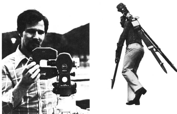
Bild 1, links. Das elektrooptische Distanzmessgerät DM 501, auf das Fernrohr des Sekundentheodoliten DKM 2-A aufgesetzt. Am Stativ das Speisegerät mit Ladeteil. Das Speisekabel führt zum feststehenden Theodolitunterteil und behindert deshalb die freie Bewegung des Instrumentes nicht.
