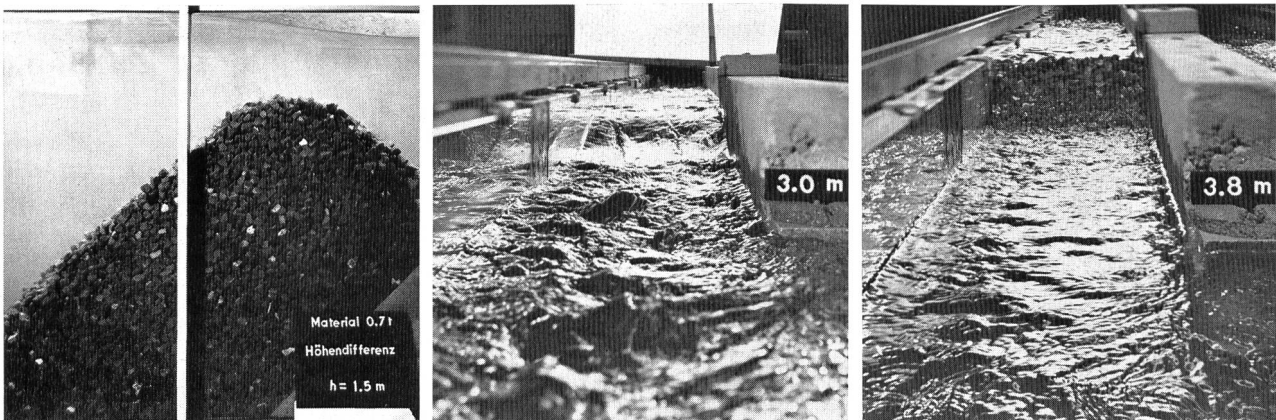
Bild 6. Gleichmässige Schüttung in einer Laborrinne, seitliche und Unterwasseransicht, Blockgewicht 0,7 t, Wasserspiegeldifferenz 1,5 m (links), 3,0 m (Mitte) und 3,8 m (rechts).
