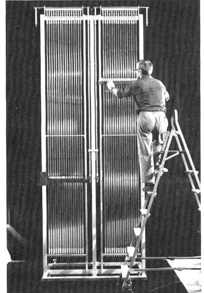
Bild 4. Eine «Messharfe» von Standrohren zur Messung von Drücken in hydraulischen Versuchsanlagen.
