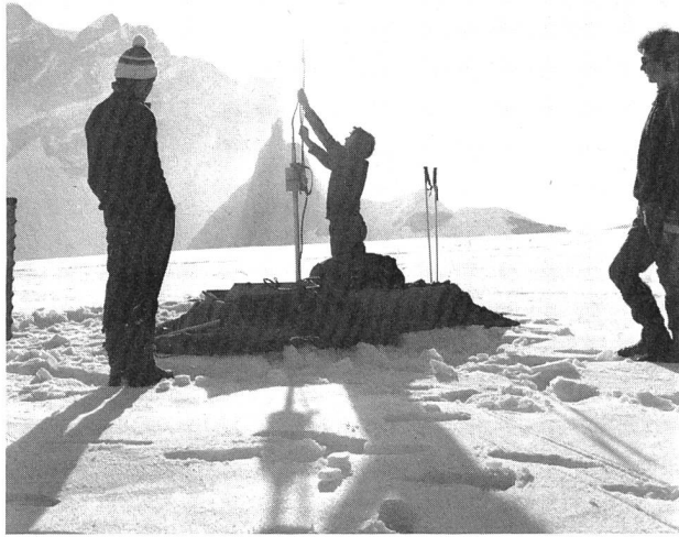
Bild 7. Schneedichtemessungen mit einer Neutronensonde auf dem Jungfraujoch.
