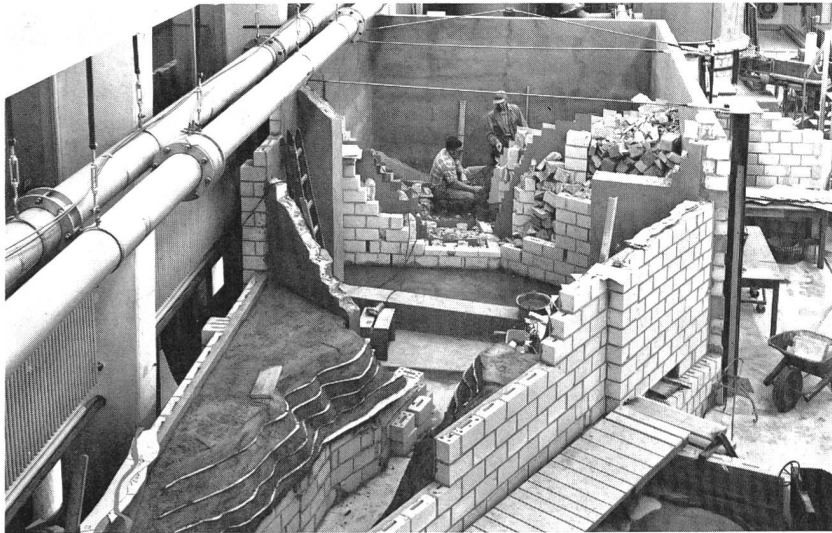
Bild 3. Bau eines hydraulischen Modells für eine ausländische Talsperre. Nachbildung der Topographie.
