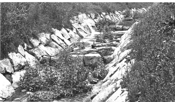
Bild 8. Mosul-Modell. Ausschnitt des Hochwasserentlastungsgerinnes. Abfluss einer Wassermenge von 10\,000\text{ m}^3/\text{s} (Natur) über den Skisprung am unteren Ende der Schussrinne.
