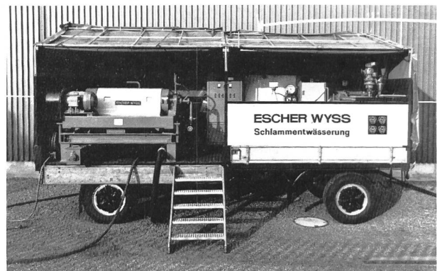
Bild 1. Mobile Pilotanlage einsatzbereit in einem Industriebetrieb.
