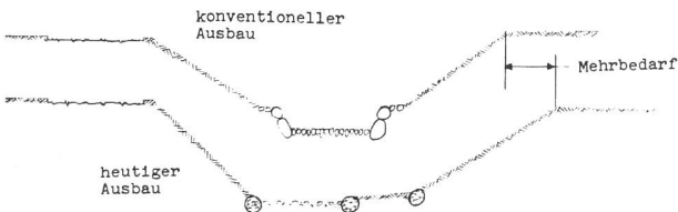
Bild 1. Vergleich eines konventionellen Ausbaues mit dem heutigen Ausbau. Der Mehrbedarf an Land beträgt im Mittel 1,2 m.
