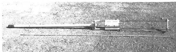
Figure 1. La carotteuse pour la prise d'échantillon du fond.
