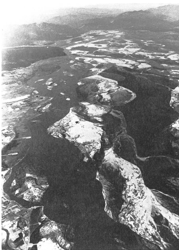
Bild 5. Luftaufnahme des Sapt Kosi im flachen Terai. Der grösste Fluss Nepals erreicht hier nahe der indischen Grenze Breiten von 5 bis 10 km. Einzelne, viele Hektaren grosse Inseln, welche längere Zeit nicht überflutet worden sind, werden sogar bewohnt und bebaut. Links im Bild (rechtes Flussufer) erkennt man einige Flussverbauungen (Buhnen), im Hintergrund den Austritt des Flusses aus den Hügeln und als Horizont den zweithöchsten Berg der Welt (Kangchenjunga 8598 m), der das Einzugsgebiet des Sapt Kosi im Osten begrenzt.
