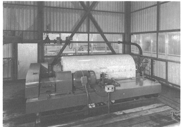
Bild 1. Zentrifugaldekanters Typ ZDC-100 mit 1000mm Trommeldurchmesser von Escher Wyss.
