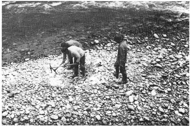
Bild 2. Entnahme einer Deckschichtprobe bei Niederwasser im November 1980. Die der Deckschicht angehörenden Steine werden durch Aufstreuen von Weisskalk identifiziert. Die angefrorenen Steine werden sodann mit Pickeln gelöst.
