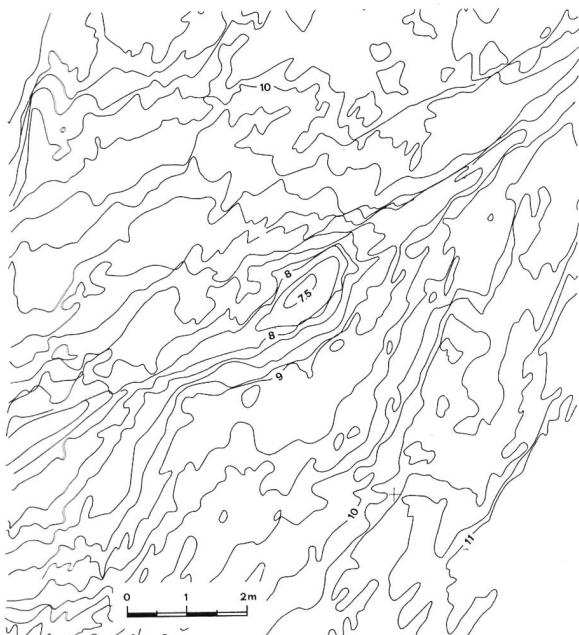
Bild 7. Ausschnitt aus den Vertikalschnitten beim Gierner Crest (Hohenrätien). Aufnahme mit Wild P 31: Basis etwa 8,5 m und Distanz etwa 45 m. Analytische Auswertung mit Wild BC 1: Äquidistanz der Kurven 25 cm; mittlerer Koordinatenfehler in der Projektionsebene nach äusserer Orientierung auf 9 Passpunkte: \pm 6 mm. Window-Plot ab Tape mit Aviotab Ta 2.
