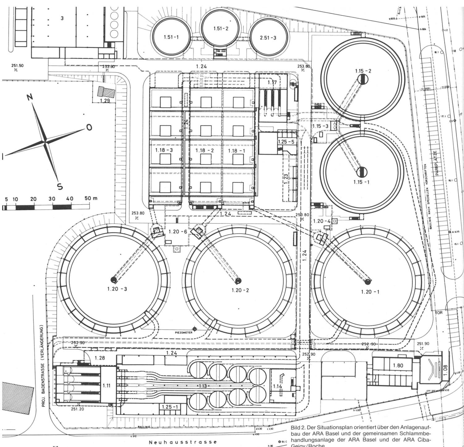
Bild 2. Der Situationsplan orientiert über den Anlagenaufbau der ARA Basel und der gemeinsamen Schlammbehandlungsanlage der ARA Basel und der ARA Ciba-Geigy/Roche.
