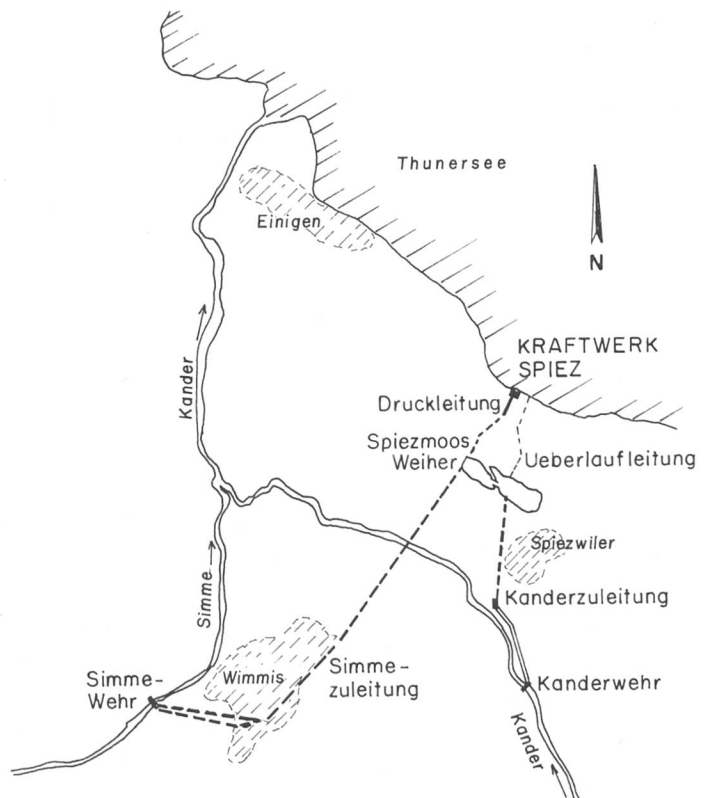
Bild 1. Übersichtsskizze Kraftwerk Spiez im Massstab von etwa 1:60000.
