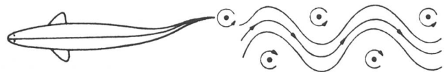
Bild 1. Durch seine Körperbewegung unter Zuhilfenahme von Wirbeln erzeugt der schwimmende Fisch einen «raketenähnlichen» Antrieb.
