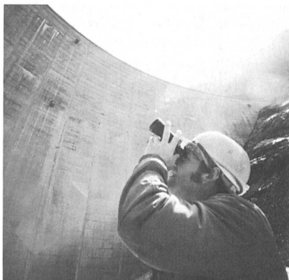
Bild 4, links. Deformationsmessung an der Staumauer Limmern. Mit dem Koordiskop wird die Abweichung des Lots bestimmt. Bild 5, Mitte. Die Staumauer Limmern; maximale Höhe 146 m, Mauerstärke am Fuss 25 m, Länge der Krone 370 m. Bild 6, rechts. Auch die Batterien müssen kontrolliert werden. (Fotos Schönwetter, Glarus)
