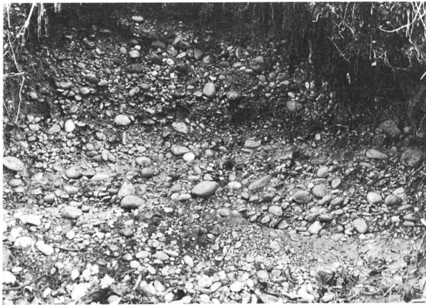
Bild 2. Detailausschnitt aus einem Anriss eines fluvioglazialen Schotters mit einem sogenannten präferentiellen Fließweg, das heisst einer Schicht aus sandfreiem Kies.
