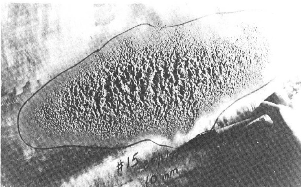
Figure 7. Dégâts de cavitation observés sur les aubes d'une turbine Francis d'une puissance de 250 MW.
