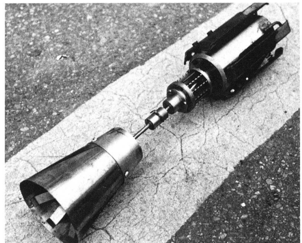
Schleudermaschine für Kunststoffbeschichtung in Röhren mit Glätter.
