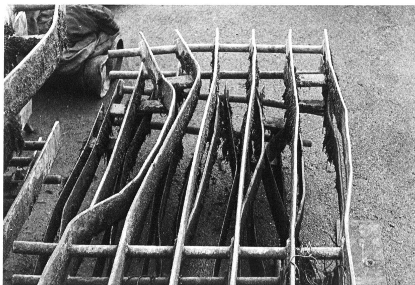
Bild 10, rechts. Einseitige, stark deformierte ausgebaute Rechenfelder der zweiten Generation. Diese ausgebauten Rechenfelder standen in Zonen stärkerer Beanspruchung durch Vibrationen und Geschwemmselbelastung.
