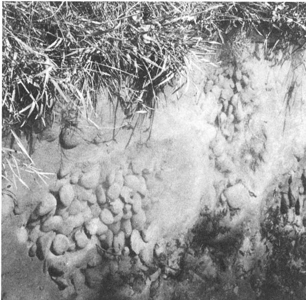
Bild 4. Feinmaterialaustrag in den Seitenkanal.
