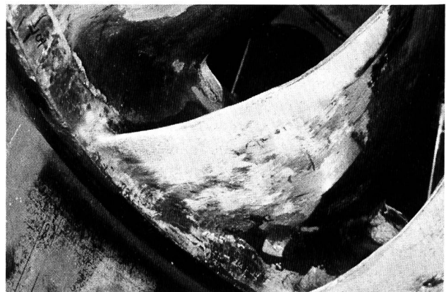
Figure 4. Roue turbine Francis, sortie d'aube réparée.
