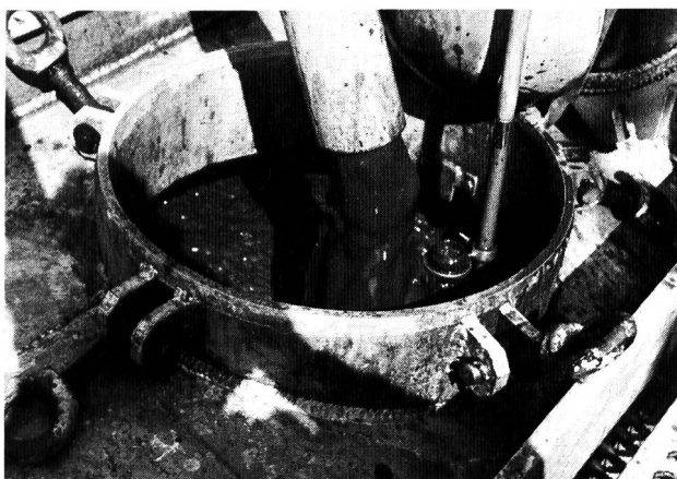
Bild 4. Hygienisierter, geruchsfreier Märstetter-Klärschlamm beim Abfüllen in ein landwirtschaftliches Transportfahrzeug. (Bilder UTB)
