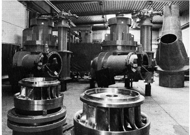
Francis-Kompaktturbinen 84 kW, Peru
