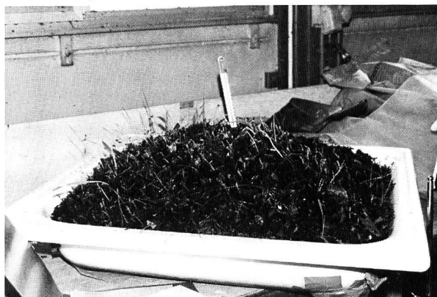
Bild 5. Versuchsanordnung zur Bestimmung der Stoffbilanzen bei der Kompostierung von Garten- und Küchenabfällen.
