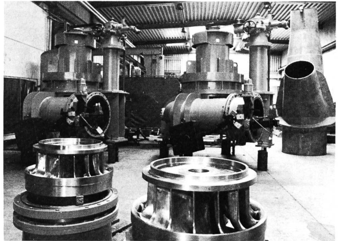
Francis-Kompaktturbinen 84 kW, Peru
