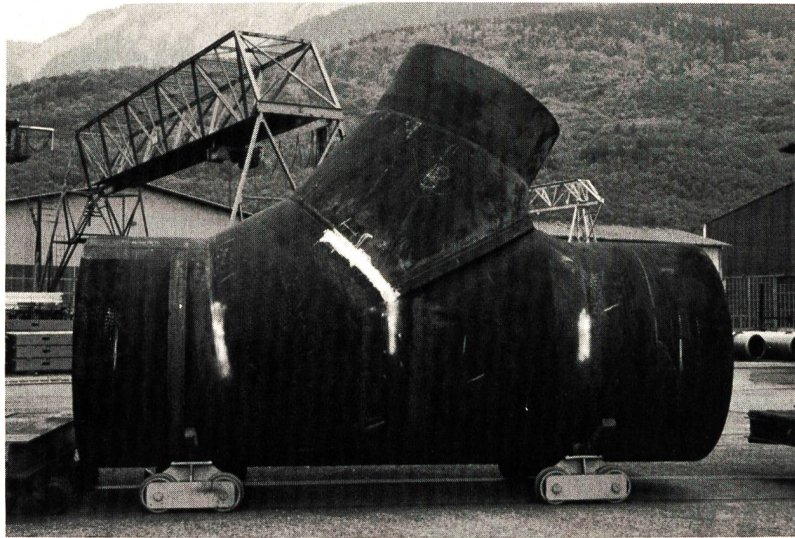
L'une des trois bifurcations fabriquées en sous-traitance par Sulzer-Escher Wyss
