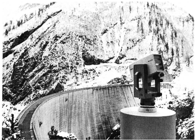
Das Mekometer Kern ME 5000: haargenauer Präzisionsdistanzmesser im wahrsten Sinne des Wortes!
