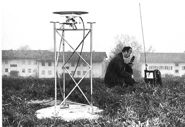
Figure 1. Grâce à une nouvelle méthode de mesurage par satellites et à la demande de la Cédra (Société coopérative nationale pour l'entreposage de déchets radioactifs), l'Office fédéral de topographie a, au cours de l'automne 1988, déterminé au millimètre près la position de 24 points de contrôle se trouvant dans le nord de la Suisse. La photo montre l'antenne dressée au-dessus d'un point de mesurage logé dans le béton (au milieu de la photo). Les signaux reçus qui ont été émis par les satellites sont transmis par câble à un appareil récepteur transportable. Un spécialiste en mesures terrestres (à droite, avec un poste émetteur-récepteur) surveille l'installation de réception pendant le déroulement des mesures.
