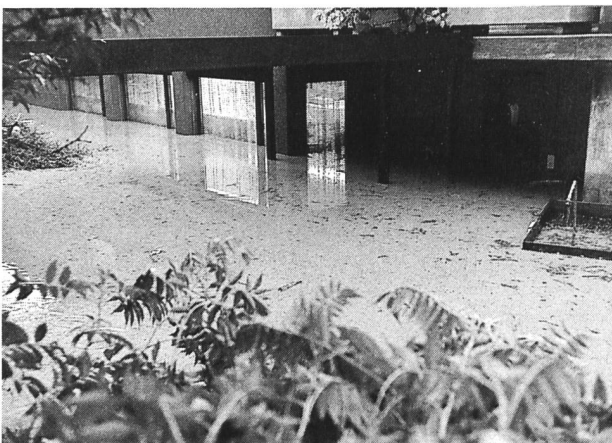
Bild 6. Das Hochwasser vom 16. Juni 1988 in Willisau/LU. Oberhalb Willisau vermag das Bachbett der Enziwigger ein Hochwasser von rund 60 \text{ m}^3/\text{s} abzuleiten. Auf Stadtgebiet verengt sich das Bachbett auf eine Durchflusskapazität von etwa 20 \text{ m}^3/\text{s} und wirkt dadurch als Flaschenhals. Ironie des Schicksals: Auch das Ingenieurbüro mit Projektunterlagen für eine Erweiterung des zu engen Bachbettes wurde massiv überflutet. Bei der Auflage des Projektes (vor dem Unwetter!) war die Notwendigkeit einer Bacherweiterung noch teilweise angezweifelt worden. Die Aufnahme zeigt das überschwemmte Ingenieurbüro. (Foto: Foto-Kino Schaller, Willisau)
