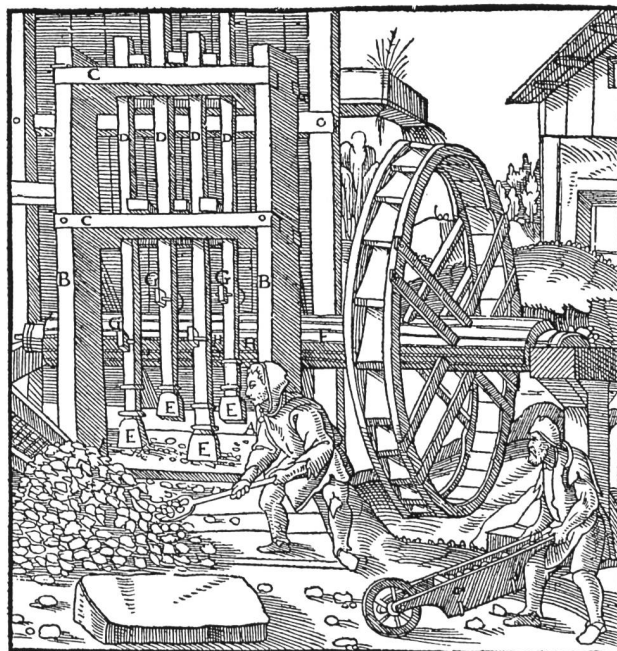
Bild 14. Erzstampfe mit vertikalen Stempeln, die durch Nocken an der Welle eines überschlächtingen Wasserrades gehoben und wieder fallen gelassen werden (aus G. Agricola: De re metallica libri XII. Basel 1556).
