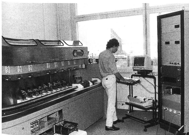
GWF-Mitarbeiter am Heisswasserzählerprüfstand.
