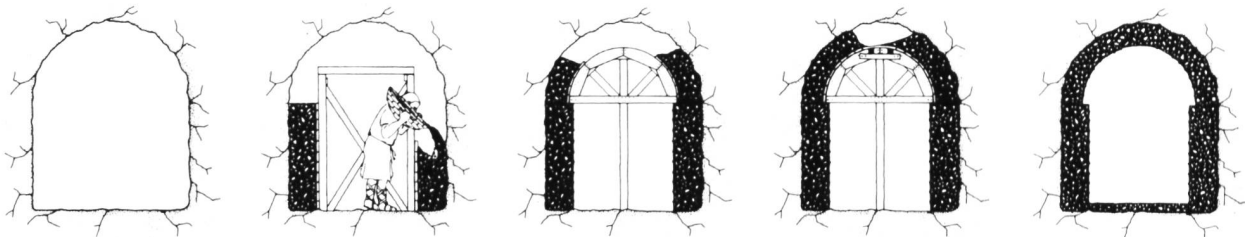
Bild 2. Bau einer römischen Wasserleitung – Tunnelstrecke mit Betonauskleidung.
