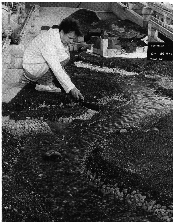
Bild 4. Entwicklung eines Hochwasserschutzprojektes im Raume Gurtnellern nach der Unwetterkatastrophe vom August 1987 (Modell der Reuss im Massstab 1:60).
