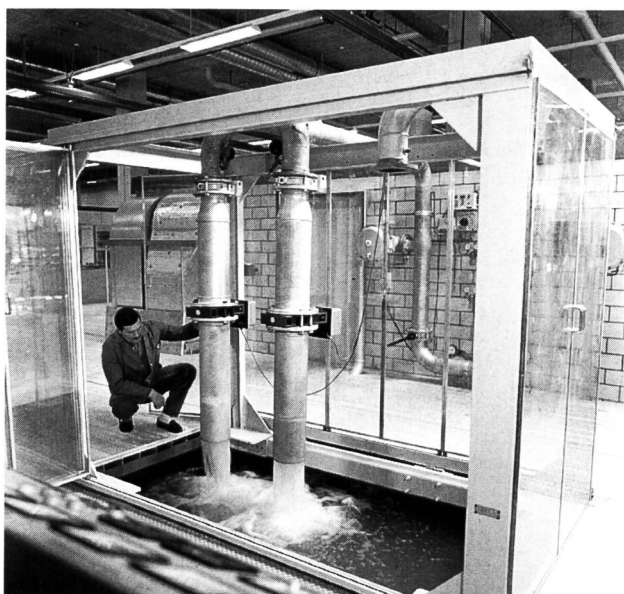
Lebensdauer-Prüfung an Ventilen und Armaturen, Prüfmethode: zyklisches Öffnen und Schliessen der Armatur bei vorgegebenem Druck.
