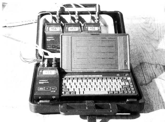
Bild 1. Messkoffer mit Subnotebook und Leitfähigkeitsmessgerät.
