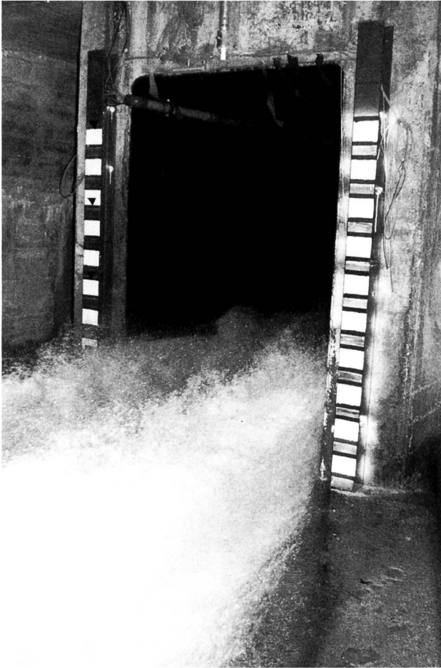
Bild 4. Fotoaufnahme der Strömung am Austritt aus dem Stollen des Grundablasses in Panix, beaufschlagt mit 15 \text{ m}^3/\text{s} und bei ca. 18 \text{ m/s} Geschwindigkeit. Die vertikale Skala links weist eine Dezimeterteilung auf.
