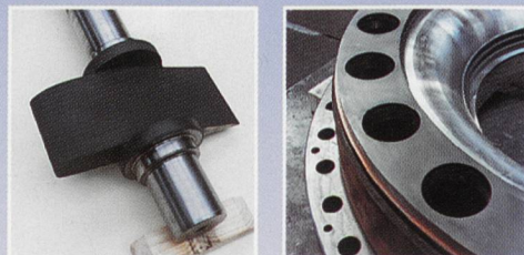
Beispiele für keramikbeschichtete Bauteile aus hydraulischen Maschinen
